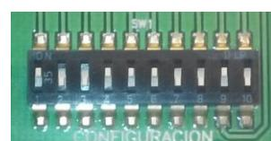
La control de flujo se hace de forma digital, por lo que es preciso parametrizar los datos de protocolo mediante 10 microinterruptores:
