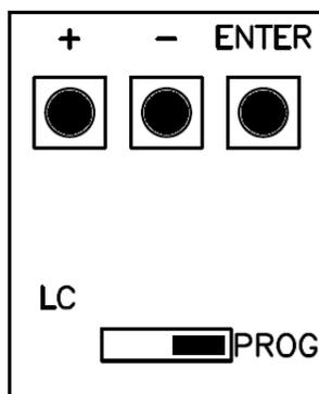
En la parte trasera del módulo hay tres pulsadores y un interruptor deslizable para el proceso de puesta en hora:
