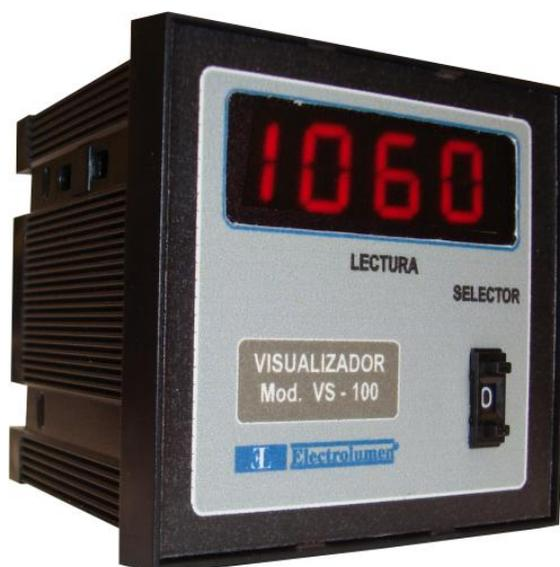
**VS – 100** es un visualizador para panel de 3 ½ dígitos de 13mm, con entrada de 0 – 20mA y tres entradas de 24V optoacopladas para la iluminación de los puntos decimales. También dispone de un preselector de un dígito y cuatro salidas BCD con contactos libres de potencial.
